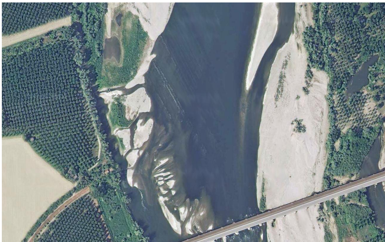
Foto 1: Ripresa aerea in cui è evidente l'affioramento del basamento marino in strati paralleli in sponda destra del F. Po, nei pressi del ponte che collega il territorio comunale a Valenza, in Provincia di Alessandria.
